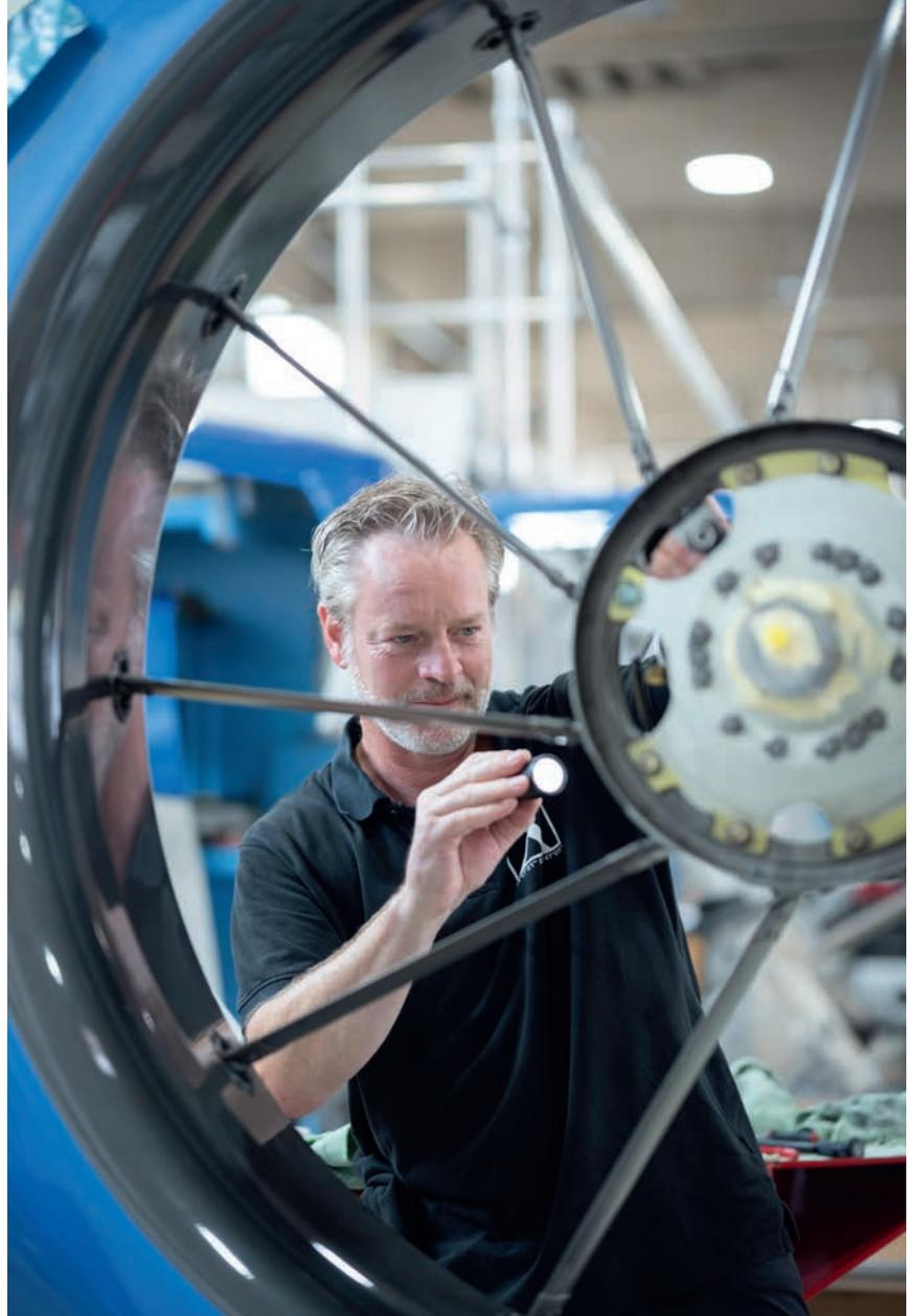
Mechaniker Marc Dietel inspiziert den Heckrotor eines Airbus H145.
